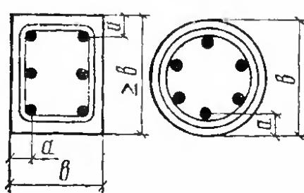
Рис. 1. Расстояния до оси арматуры
