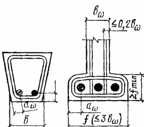
Рис. 3 Армирование балок и расстояния до оси арматуры
